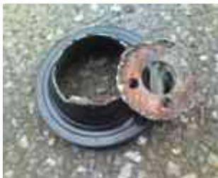
今、着けているWグローブプーリーと同じものがもう一つ有り、切り詰めて合わせようと思ったが、我が家の小型旋盤では大きすぎて切断作業が出来ず。壊れたプーリーを再生のため溶接してみました。ガッチリ溶接して旋盤に着けて回したところVベルト部分の振れは無かったのですが。ウォーターポンプ取り付け部の振れは半端では有りません。芯が出ていないプーリーで良く今まで動いていたかと思うと怖い思いです。
